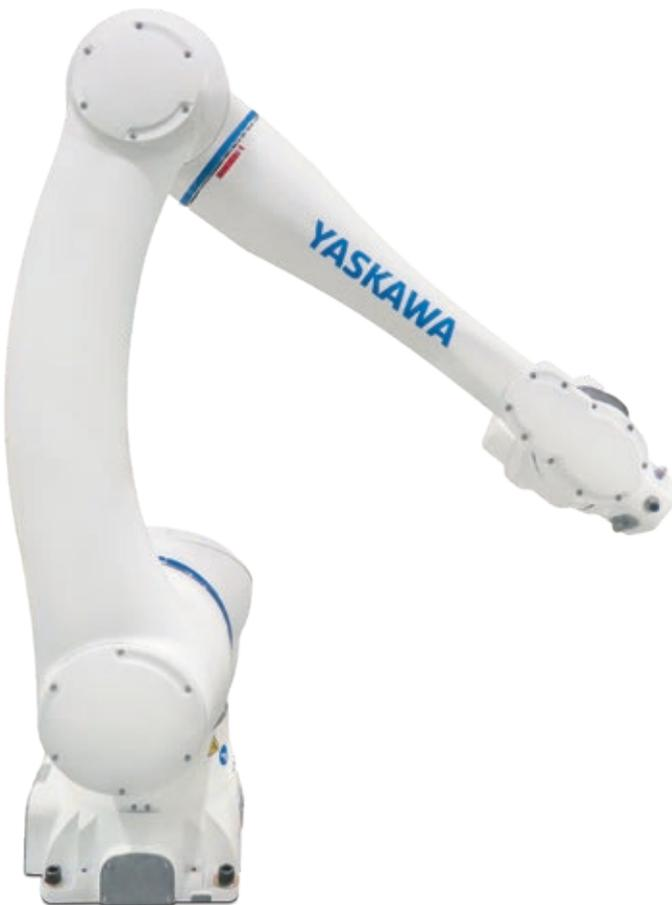
die Überwachung und Auswertung externer Kräfte ist es möglich, den Roboterarm direkt mit der Hand zu führen und zu programmieren. Hierdurch ergibt sich ein Zeitersparnis bei der Erstellung von Roboterprogrammen. Die Programmierung erfolgt optional über „Teach“- und „Tool“-Knöpfe, direkt über den Roboterarm. Der Roboterarm wurde so konstruiert, dass keine Quetschbereiche (Finger) vorhanden sind.
