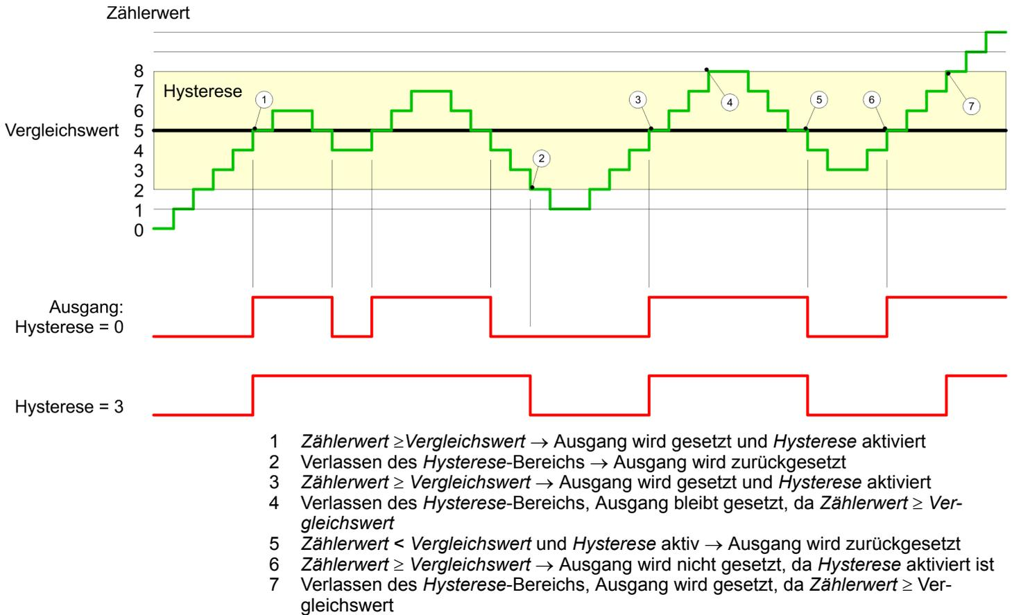
Mit dem Erreichen der Vergleichsbedingung wird die *Hysteresis* aktiv. Bei aktiver *Hysteresis* bleibt das Vergleichsergebnis solange unverändert, bis der Zählerwert den eingestellten *Hysteresis*-Bereich verlässt. Nach Verlassen des *Hysteresis*-Bereichs wird erst wieder mit Erreichen der Vergleichsbedingungen die *Hysteresis* aktiviert.
