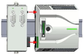
5. Schieben Sie zur Fixierung des Erweiterungsmoduls auf der Tragschiene die Verriegelungshebel wieder zurück in die Ausgangsposition.
