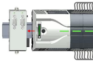
4. ➔ Ziehen Sie das Erweiterungsmodul durch Verschieben auf der Tragschiene von der CPU ab.
