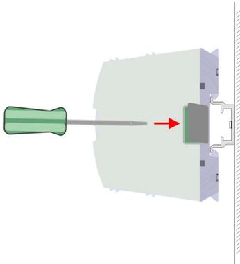
2. Das Peripheriemodul besitzt an der Ober- und Unterseite einen Verriegelungshebel. Ziehen Sie diese Hebel wie in der Abbildung gezeigt soweit nach außen, bis diese hörbar einrasten.
