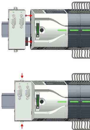
8. Binden Sie das Erweiterungsmodul wieder an die CPU an, indem Sie das Erweiterungsmodul auf der Tragschiene nach rechts schieben, bis der Schnittstellen-Anschluss in der CPU leicht einrastet.
