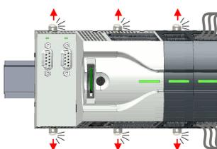
1. Entfernen Sie die Module, welche an das zu tauschende Modul angebunden sind, indem Sie deren Entriegelungshebel soweit nach außen ziehen, bis diese hörbar einrasten ...
