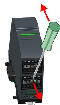
8. ➔ Entfernen Sie die überflüssigen Steckverbinder.
