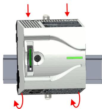
3. Stecken Sie die CPU von oben auf die Tragschiene und drehen Sie die CPU nach unten, bis dieses auf der Tragschiene aufliegt.
