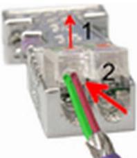
1. ➤ Lösen Sie die Schraube.
