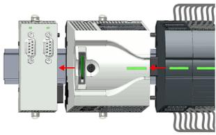
2. ➔ Ziehen Sie alle an die CPU angebotenen Module ab, indem Sie die CPU zusammen mit dem Erweiterungsmodul auf der Tragschiene entsprechend verschieben.
