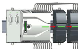
6. ➔ Verbinden Sie alle Module wieder, indem Sie diese auf der Tragschiene entsprechend wieder zusammenschieben.
