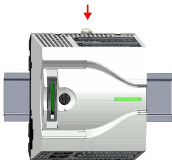
6. ➤ Schieben Sie zur Fixierung der CPU auf der Tragschiene die Verriegelungshebel wieder zurück in die Ausgangsposition.
