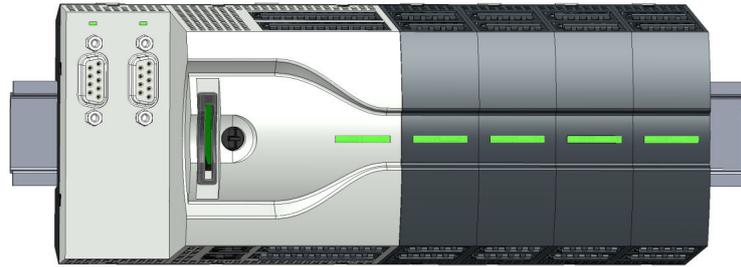
Das System MICRO ist ein modular aufgebautes Automatisierungssystem für die Montage auf einer 35mm Tragschiene. Mittels Peripheriemodule können Sie dieses System an Ihre Automatisierungsaufgaben adaptieren. Zusätzlich besteht die Möglichkeit Ihre CPU um entsprechende Schnittstellen zu erweitern. Der Verdrahtungsaufwand ist gering gehalten, da die DC 24V Elektronikversorgung im Rückwandbus integriert ist und defekte Geräte bei stehender Verdrahtung getauscht werden können.
