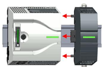
5. Schieben Sie zur Fixierung des Peripheriemoduls auf der Tragschiene die Verriegelungshebel wieder zurück in die Ausgangsposition.
