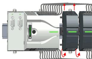
3. ➔ Nehmen Sie das Peripheriemodul mit einer Drehung nach oben von der Tragschiene ab.
