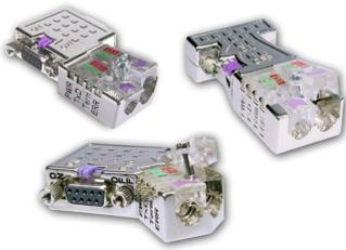
In PROFIBUS werden alle Teilnehmer parallel verdrahtet. Hierzu ist das Buskabel durchzuschleifen. Unter der Best.-Nr. 972-ODP10 erhalten Sie von VIPA den Stecker "EasyConn". Dies ist ein Busanschlussstecker mit zuschaltbarem Abschlusswiderstand und integrierter Busdiagnose.
