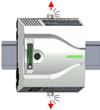
2. ➔ Nehmen Sie die CPU mit einer Drehung nach oben von der Tragschiene ab.
