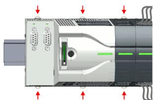
7. ➔ Schieben Sie die Verriegelungshebel wieder zurück in die Ausgangsposition.
