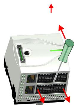
7. ➤ Entfernen Sie die überflüssigen Steckverbinder an der CPU.
