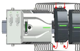
5. ➔ Stecken Sie das Peripheriemodul von oben auf die Tragschiene und drehen Sie das Peripheriemodul nach unten, bis dieses auf der Tragschiene aufliegt.
