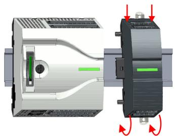
4. Binden Sie das Peripheriemodul an die CPU an, indem Sie das Peripheriemodul auf der Tragschiene nach links schieben, bis der Schnittstellen-Anschluss in der CPU leicht einrastet.
