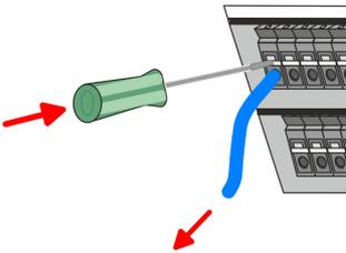
Das Entfernen eines Drahtes erfolgt mittels eines Schraubendrehers mit 2,5mm Klingenbreite.
