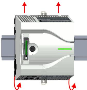
3. ➔ Ziehen Sie die Entriegelungshebel der CPU soweit nach außen, bis diese hörbar einrasten.
