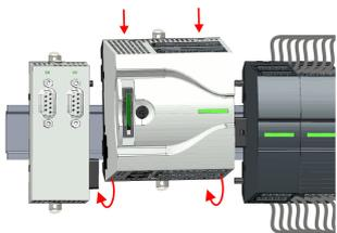
5. ➔ Zur Montage der CPU ziehen Sie die Verriegelungshebel so weit nach außen, bis diese hörbar einrasten. Stecken Sie die CPU von oben auf die Tragschiene und drehen Sie die CPU nach unten, bis diese auf der Tragschiene aufliegt.
