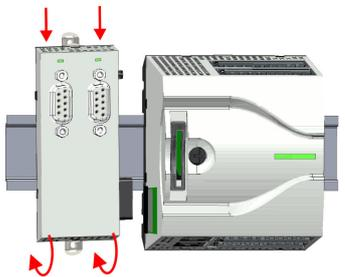
4. Binden Sie das Erweiterungsmodul an die CPU an, indem Sie das Erweiterungsmodul auf der Tragschiene nach rechts schieben, bis der Schnittstellen-Anschluss in der CPU leicht einrastet.
