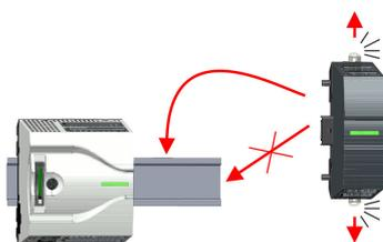
4. ➔ Ziehen Sie die Entriegelungshebel des Peripheriemoduls soweit nach außen, bis diese hörbar einrasten.
