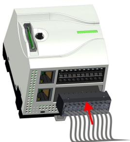
8. ➤ Stecken Sie wieder die verdrahteten Steckverbinder.
