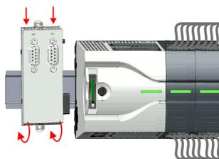
7. ➔ Zur Montage stecken Sie das Erweiterungsmodul von oben auf die Tragschiene und drehen Sie das Erweiterungsmodul nach unten, bis dieses auf der Tragschiene aufliegt.
