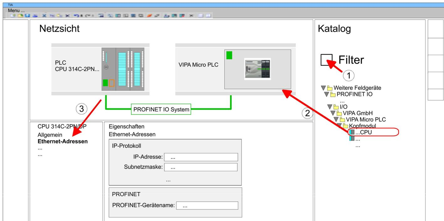
5. ➤ Wählen Sie in der *Netzansicht* das IO-Device "VIPA MICRO PLC" an und wechseln Sie in die *Geräteübersicht*.
