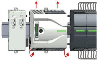
3. ➔ Nehmen Sie die CPU mit einer Drehung nach oben von der Tragschiene ab.
