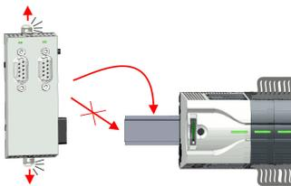
6. ➔ Ziehen Sie die Entriegelungshebel des Erweiterungsmoduls soweit nach außen, bis diese hörbar einrasten.
