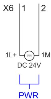
Die CPU besitzt ein eingebautes Netzteil. Das Netzteil ist mit DC 24V zu versorgen. Mit der Versorgungsspannung werden neben der CPU-Elektronik auch die Elektronik des integrierten IO-Teils versorgt. Das Netzteil ist gegen Verpolung und Überstrom geschützt.
