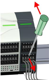
Mittels eines Schraubendrehers haben Sie die Möglichkeit z.B. für den Modultausch bei stehender Verdrahtung die Steckverbinder zu entfernen. Hierzu besitzt jeder Steckverbinder an der Oberseite Vertiefungen für die Entriegelung. Die Entriegelung erfolgt nach folgender Vorgehensweise:
