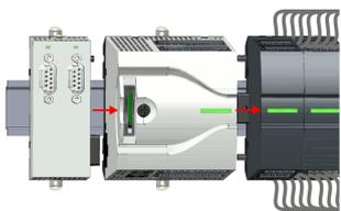
6. ➔ Binden Sie Ihre Module wieder an, indem Sie die CPU zusammen mit dem Erweiterungsmodul auf der Tragschiene entsprechend verschieben.
