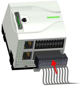
9. ➔ Stecken Sie wieder die verdrahteten Steckverbinder.
