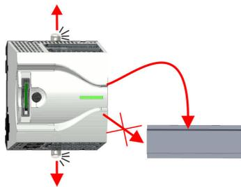
2. Die CPU besitzt an der Ober- und Unterseite einen Verriegelungshebel. Ziehen Sie diese Hebel wie in der Abbildung gezeigt soweit nach außen, bis diese hörbar einrasten.
