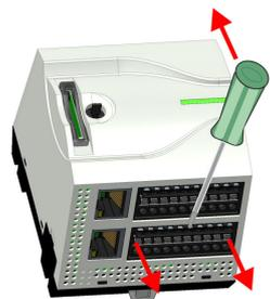
8. ➔ Entfernen Sie die überflüssigen Steckverbinder an der CPU.
