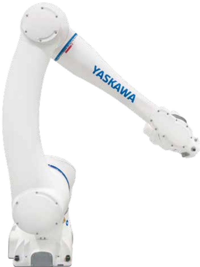
Estas características permiten ahorrar tiempo durante la programación del robot. La geometría del brazo del robot ha sido diseñada para evitar puntos de pinzamiento (protección de los dedos).
